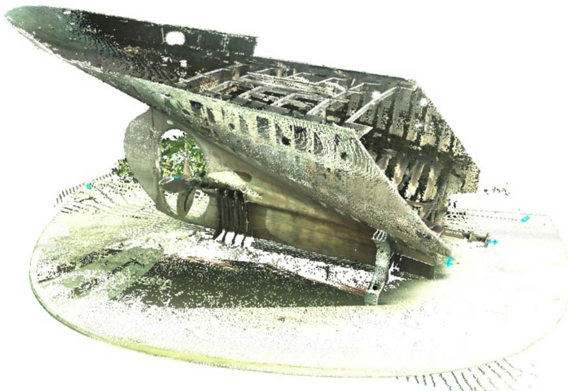
Fig. 12. Il relitto della nave Elettra. Telespazio, Fucino. Vista prospettica renderizzata della nuvola di punti complessiva
