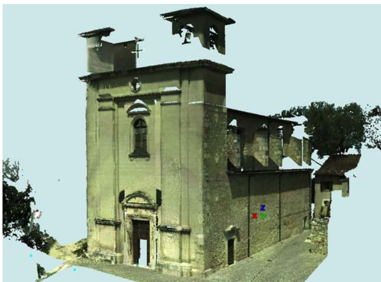
Fig. 1. Chiesa di Santa Croce ad Antrosano, Avezzano, L'Aquila. Nuvola dei punti renderizzata dell'esterno, in cui sono evidenti le lacune dovute a fattori di forma interna (cornici e contrafforti) ed a fattori di interferenza esterna (presenza di un fabbricato quasi a ridosso della zona posteriore).
